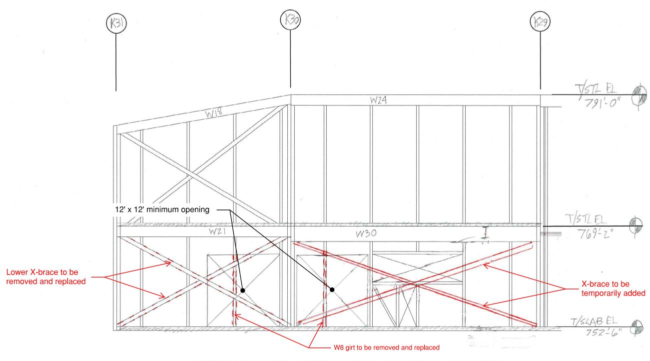
MODIFICATION TO EXTERIOR WALL FRAMING ALONG LINE Ks
